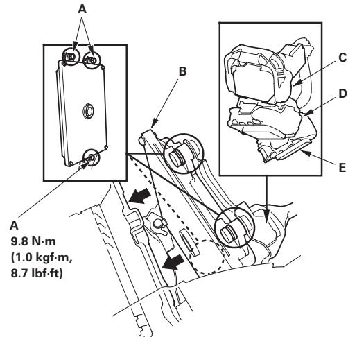
8. 断开 PCM 插接器 A (C)、B (D) 和 C (E)，然后拆下 PCM。
