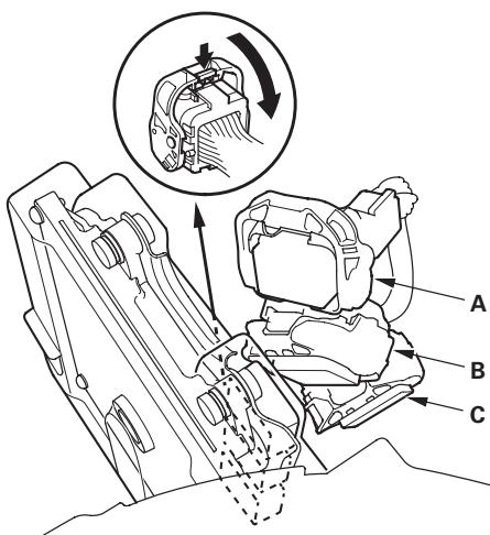
3. 将线束 (A) 端子一侧连接至数字式万用表 (B), 并将端子的另一端连接至通用 banana 插头 (Pomona 电子工具 3563 号或同等工具) (C)。
